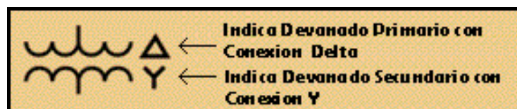
Figura 19. Símbolo Eléctrico de Transformador
